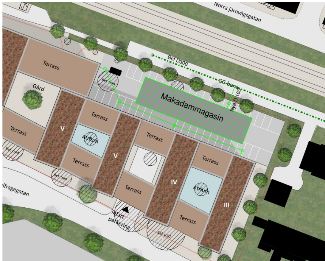
Figur 11 Föreslagen plats för makadammagasin och servisanslutning
