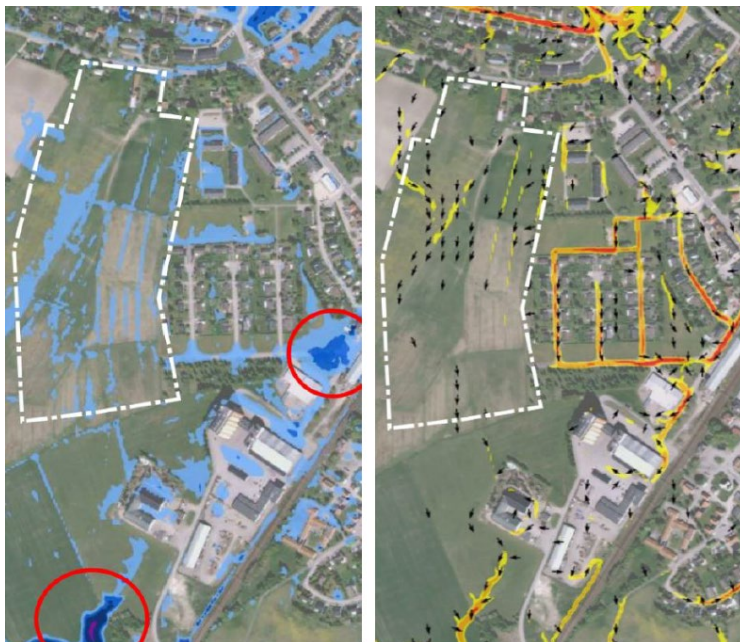
Bild: Urklipp från skyfallskartering för Vänersborgs kommun, planrådets ungefärliga gränser är markerade med vitstreckad linje. Vänster: Lågpunkter där vatten ansamlas vid ett 100 års regn. Höger: Yttlig flödesriktning (DHI 2018)
