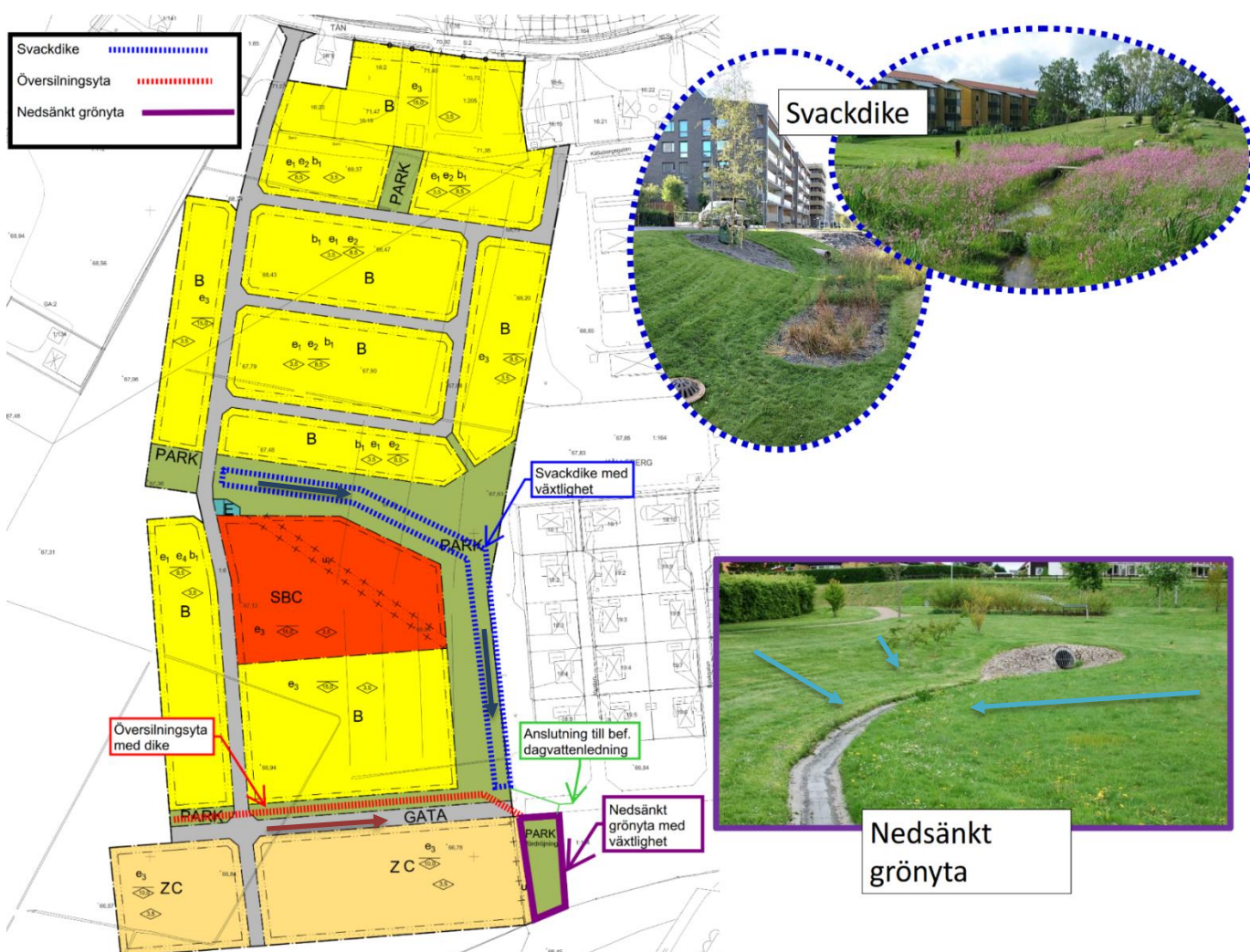
Figur 16 Föreslagen dagvattenhantering inom planområdet. Till vänster i figuren: Blå pilar visar flödesriktning i svackdike och röd pil visar flödesriktning för översilningsytan. Till höger i figuren: Blå pilar visar lutningen i den nedsänkta grönytan.
