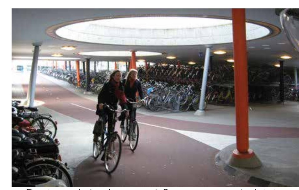
En stor cykelparkering vid Groningens centralstation. Den röda cykelbanan bidrar till effektivitet och de lutande pelarna bidrar till en trygghetskänsla
