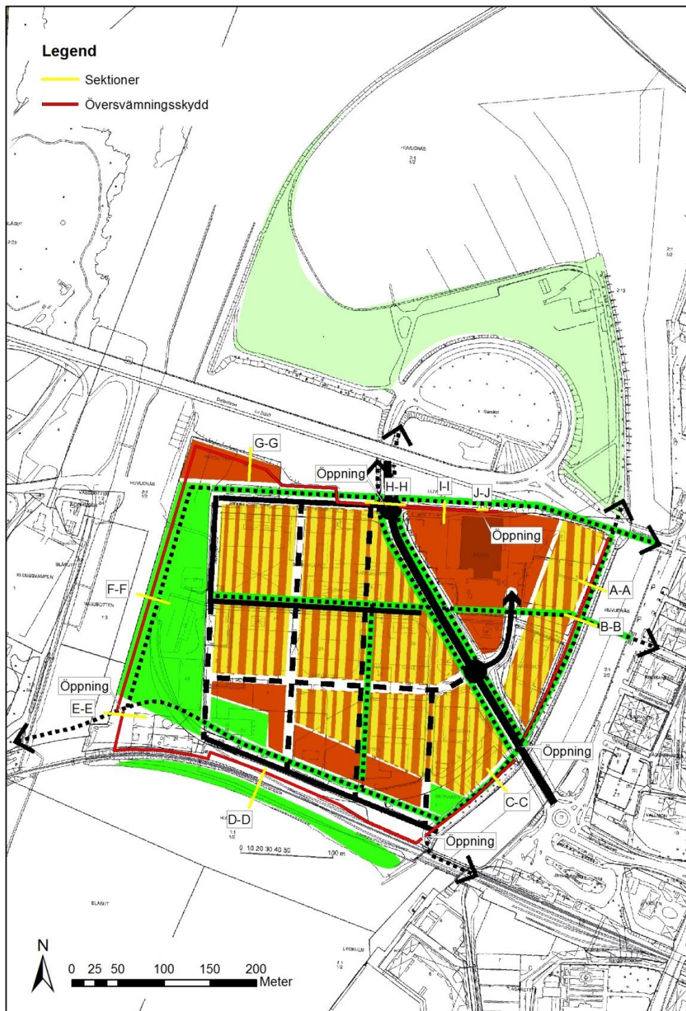
Figur 21. Planprogrammet och föreslaget översvämningsskydds sträckning med sektioner, se nedan samt kapitel 5. Detaljerad utformning. Öppningarna i skyddet är placerade efter planprogrammets vision
