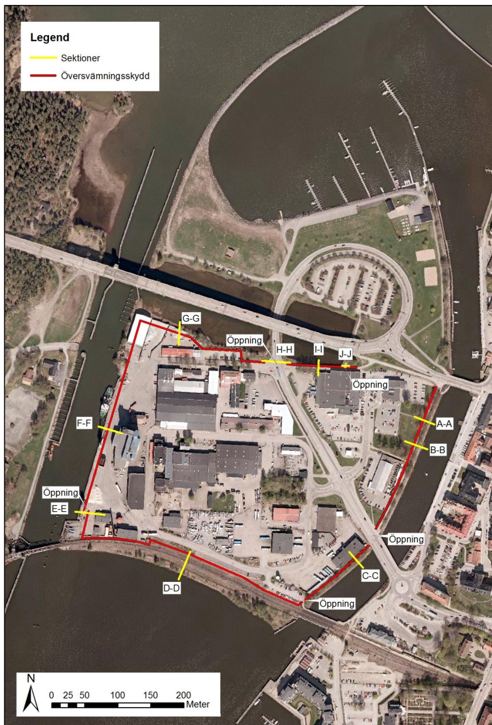
Figur 20. Föreslaget översvämningsskydds sträckning med sektioner och öppningar, se nedan samt kapitel 5. Detaljerad utformning
