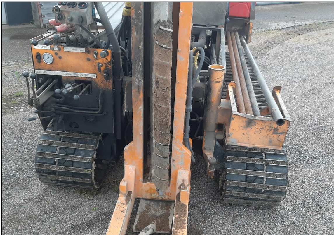
Figur 5. Foto i samband med jordprovtagning (Källa: Deka 2024). En typisk jordartsekvens från ytliga jordmassor kan ses på skruven (ca 0,7 m fyllnadsmassor ovan lera).
