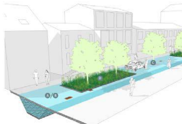
Sammanhängande dagvattenstråk i gatumiljön kan variera i utformning och inkludera ett flertal funktioner. Exempelvis regnbädd med renande funktion och parkering med genomsläpplig markbeläggning.
